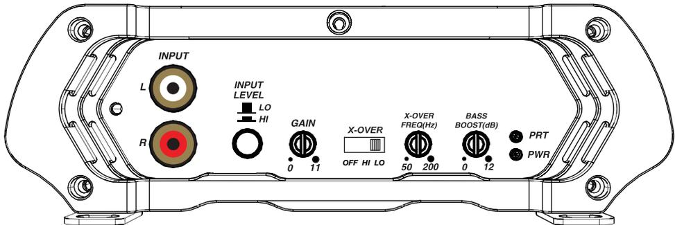
**Automatische Einschaltung:** Die DXA-Serie umfasst zwei automatische Einschaltmodi: +12V und DC Offset.
