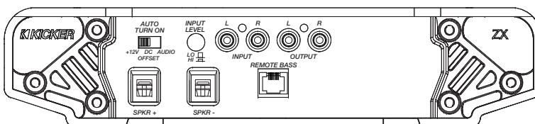
**1. Selección de encendido automático.** La serie ZX ofrece tres modalidades de encendido automático que se pueden seleccionar en el panel de extremo: +12 V, compensación de CC y audio. Las modalidades de audio o compensación de CC dan +12 V a la terminal REM para encender otros amplificadores.
