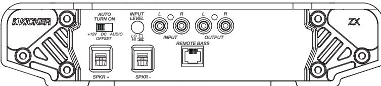
**1. Sélection de mise sous tension automatique** La série ZX est dotée de trois modes différents de mise sous tension automatique pouvant être sélectionnés au panneau d'extrémité de l'amplificateur : +12V, DC Offset (décalage c.c.) et Audio. L'utilisation du mode DC Offset ou Audio permet à la borne REM d'avoir une sortie de +12 V pour des amplificateurs supplémentaires.
