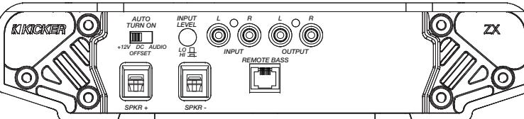
**1. Automatische Einschaltung.** Die ZX-Serie bietet drei verschiedene automatische Einschaltmethoden, die an der Endplatte gewählt werden können: +12V, DC Offset und Audio. Wenn Sie „DC Offset“ oder „Audio“ verwenden, wird am REM-Terminal +12V für das Einschalten weiterer Verstärker bereit gestellt
