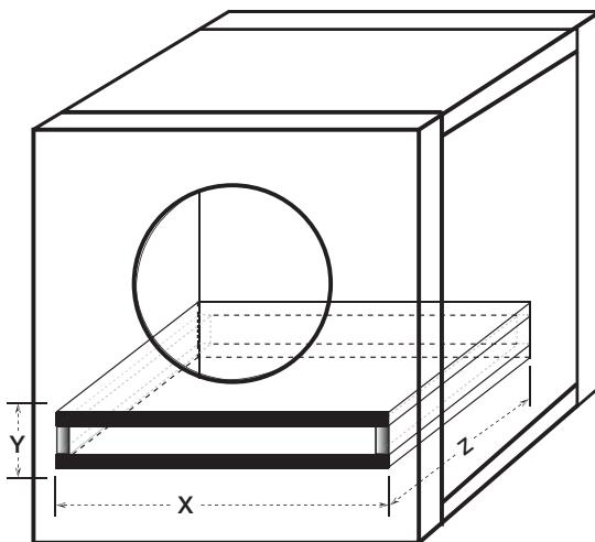
Der Hub der Reflexöffnung muss berechnet und zum inneren Volumen des endgültigen Designs hinzugezählt werden. Die Abmessungen für X, Y und Z können je nach Materialstärke variieren.
