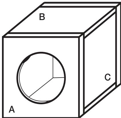
**Geschlossene Gehäuse** Der KM-Subwoofer bietet mehr Leistung als herkömmliche Marine-Lautsprecher und klingt in den empfohlenen geschlossenen Gehäusen hervorragend. Diese geschlossenen Gehäuseformen bieten die beste Wiedergabe und die meiste Energie bei den niedrigsten Frequenzen, um 20 bis 40 Hz sowie einen massiven, präzisen Bass.
