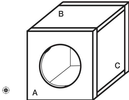
**Caissons scellés :** le caisson de basses KM génère plus de pression sonore que les systèmes pour bateau concurrents disponibles sur le marché et fonctionnent de façon optimale dans un boîtier scellé. La conception de caissons scellés offre la réponse audio la plus fluide avec une puissance accrue aux fréquences les plus basses, de 20 à 40 Hz, assurant des quantités massives de basses en haute fidélité.
