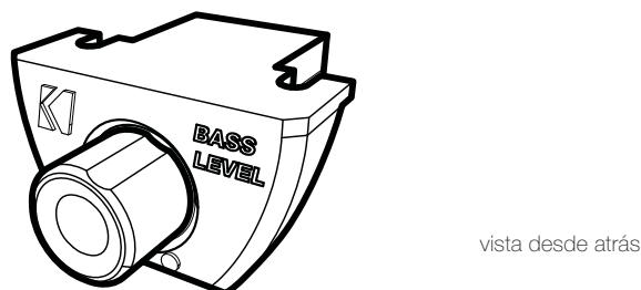
Para instalar en superficie el control remoto KXRC use los tornillos suministrados.
