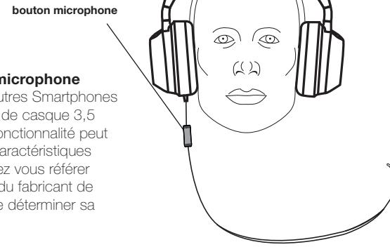
**NOTE :** le **bouton microphone** fonctionne avec d'autres Smartphones équipés d'une prise de casque 3,5 mm, cependant la fonctionnalité peut être limitée par les caractéristiques du téléphone. Veuillez vous référer à la documentation du fabricant de votre appareil afin de déterminer sa compatibilité.
