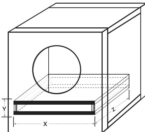
El desplazamiento del puerto debe calcularse y agregarse al volumen interno del diseño final. Las dimensiones para X, Y e Z pueden variar en base al espesor del material usado para construir el puerto.
