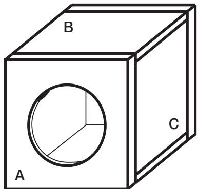
**Caissons scellés :** La conception de caissons scellés offre la réponse audio la plus fluide avec une puissance accrue aux fréquences les plus basses, de 20 à 40 Hz, assurant des quantités massives de basses en haute fidélité.
