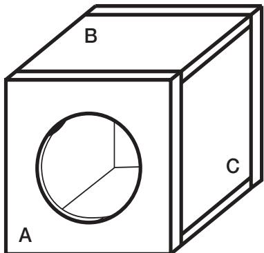
**Geschlossene Gehäuse:** Diese geschlossenen Gehäuseformen bieten die beste Wiedergabe und die meiste Energie bei den niedrigsten Frequenzen, um 20 bis 40 Hz sowie einen massiven, präzisen Bass.
