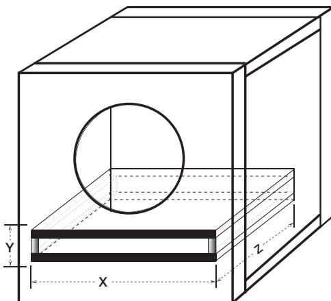
Le déplacement de l'ouverture doit être calculé et ajouté au volume interne de conception finale. Les dimensions pour X, Y et Z peuvent varier selon l'épaisseur du matériau utilisé pour construire l'ouverture.
