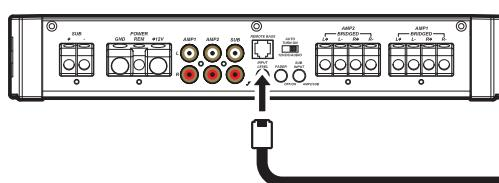
*El Mini-USB es únicamente para uso interno: NO lo retire o manipule. KICKER no se responsabiliza por aquel daño al equipo que resultare de las conexiones realizadas en este puerto.*
