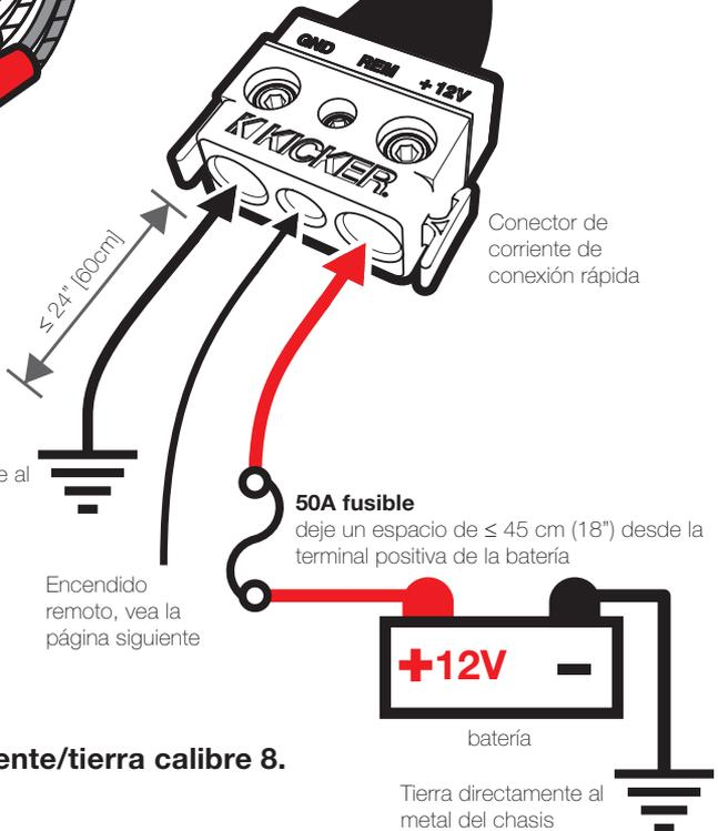
**Utilice un cable de corriente/tierra calibre 8.**
