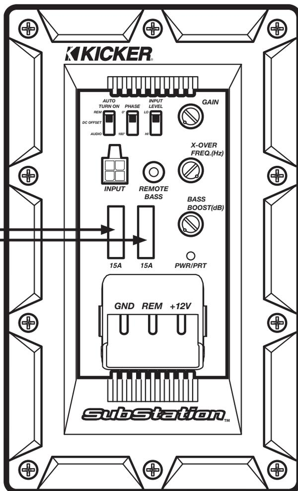
**Sélection de mise en marche automatique :** Les enceintes KICKER proposent trois modes de mise en marche, que vous pouvez sélectionner sur le panneau latéral ; +12V, DC Offset et Audio. Le fait d'utiliser le mode DC Offset ou Audio permet à la borne REM de disposer d'une sortie de +12V pour le branchement d'amplificateurs supplémentaires.
