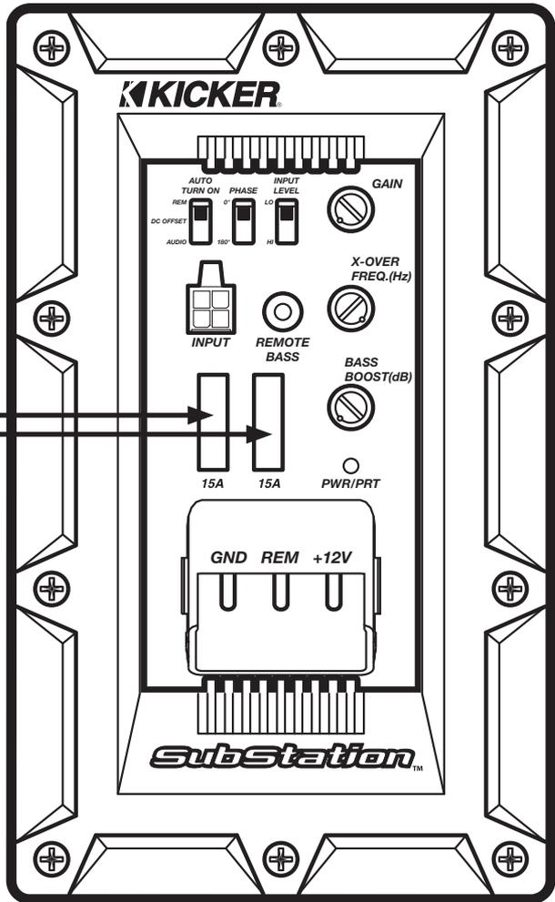
**Automatische Einschaltauswahl:** KICKER Powered Enclosures umfassen drei automatische Einschaltmodi, die an der Seite ausgewählt werden können: +12V, DC Offset und Audio. Der DC Offset- oder Audiomodus aktiviert am REM-Anschluss die +12V Ausgabe für das Einschalten zusätzlicher Verstärker.
