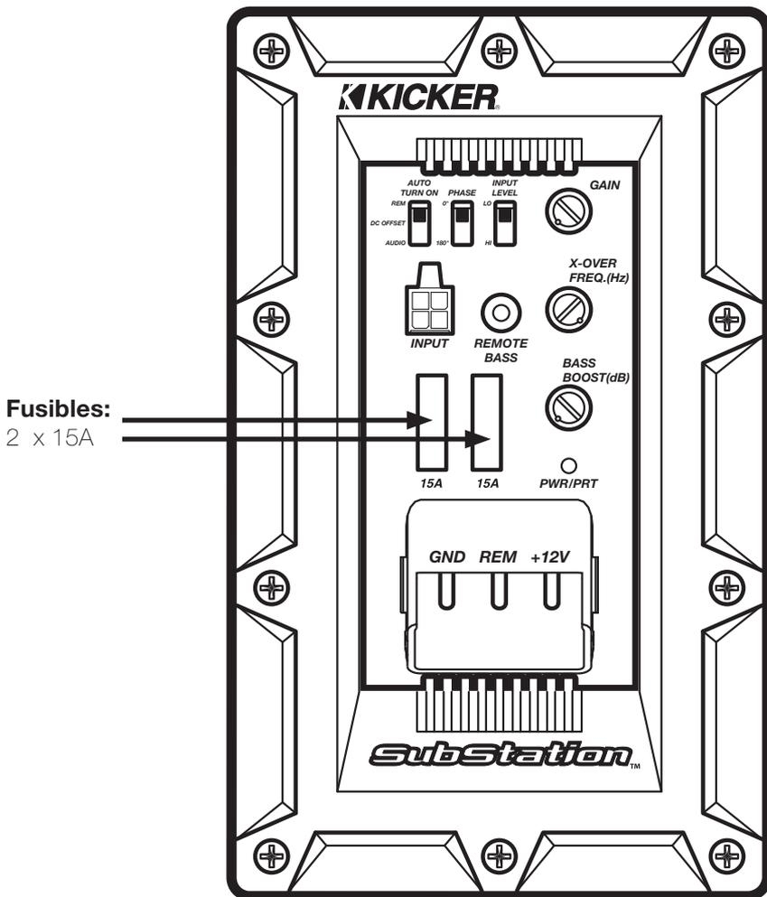
**Selección de encendido automático:** los gabinetes con la tecnología de KICKER ofrecen tres modos distintos de encendido automático que se pueden seleccionar en el panel lateral: +12V, desvío de CD y Audio. Usar el modo desvío de CD o de Audio hace que la terminal REM tenga +12V para encender amplificadores adicionales.
