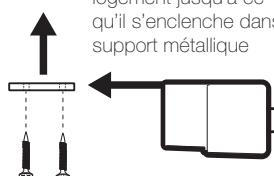
2. faites glisser le logement jusqu'à ce qu'il s'enclenche dans le support métallique
