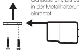
2. Schieben Sie das Gehäuse ein, bis es in der Metallhalterung einrastet.
