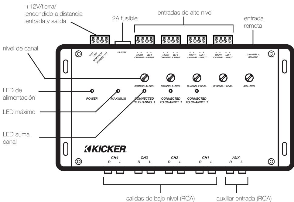
**Canal 3 Sentido de la señal:** Si no hay señal en la entrada del Canal 4, la señal conectada a la entrada de Canal 3 se pasa a los del Canal 3 y Canal 4 salidas.
