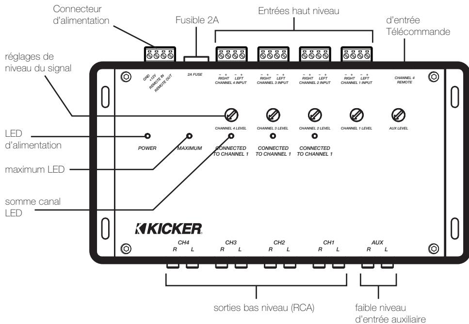
**Canal 3 Détection de signal :** Si aucun signal n'est présent lors de la 4 canal d'entrée, le signal connecté à la Chaîne 3 entrées seront acheminés à la fois le Channel 3 et Channel 4 sorties.
