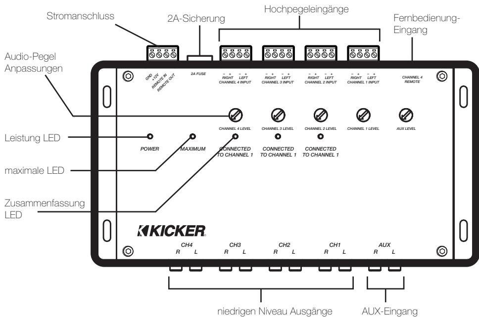
**Kanal 3 Signal Sense:** Wenn kein Signal am Eingang anliegt Channel 4, das Signal auf den Kanal 3-Eingang angeschlossen werden, um sowohl die Channel 3 und Channel 4 Ausgänge geroutet werden.
