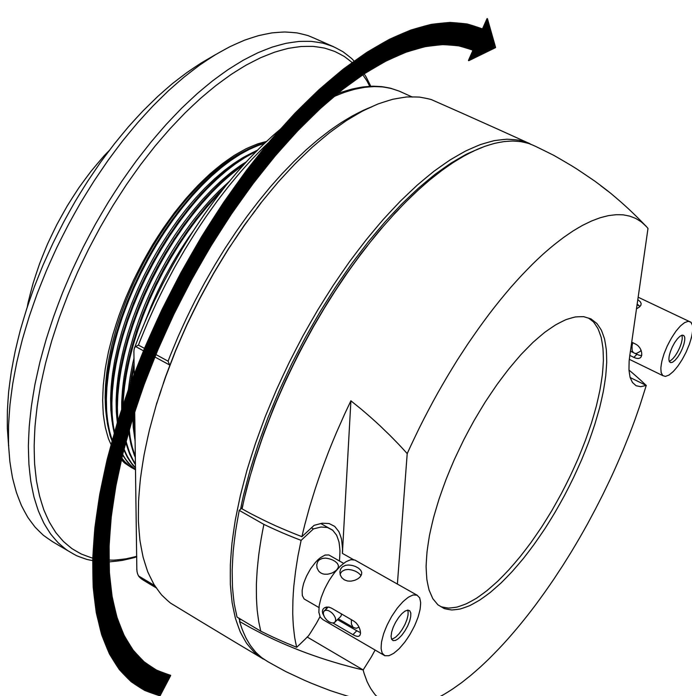
Pour un **montage en surface**, découpez un trou circulaire dans la surface de montage à 60 mm (2,375 po) pour le ST3TW, et à 75 mm (3 po) pour le ST4TW.
