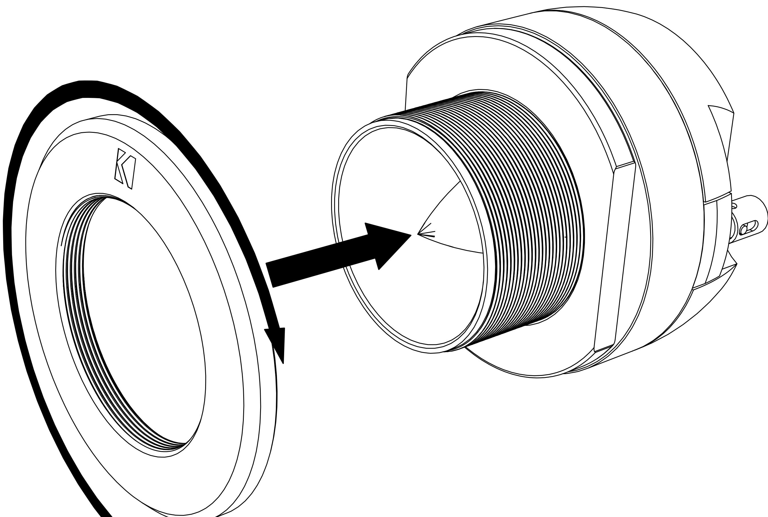
Ziehen Sie die Sicherungsmutter in Richtung der Montagefläche an, um den Hochtöner zu sichern.
