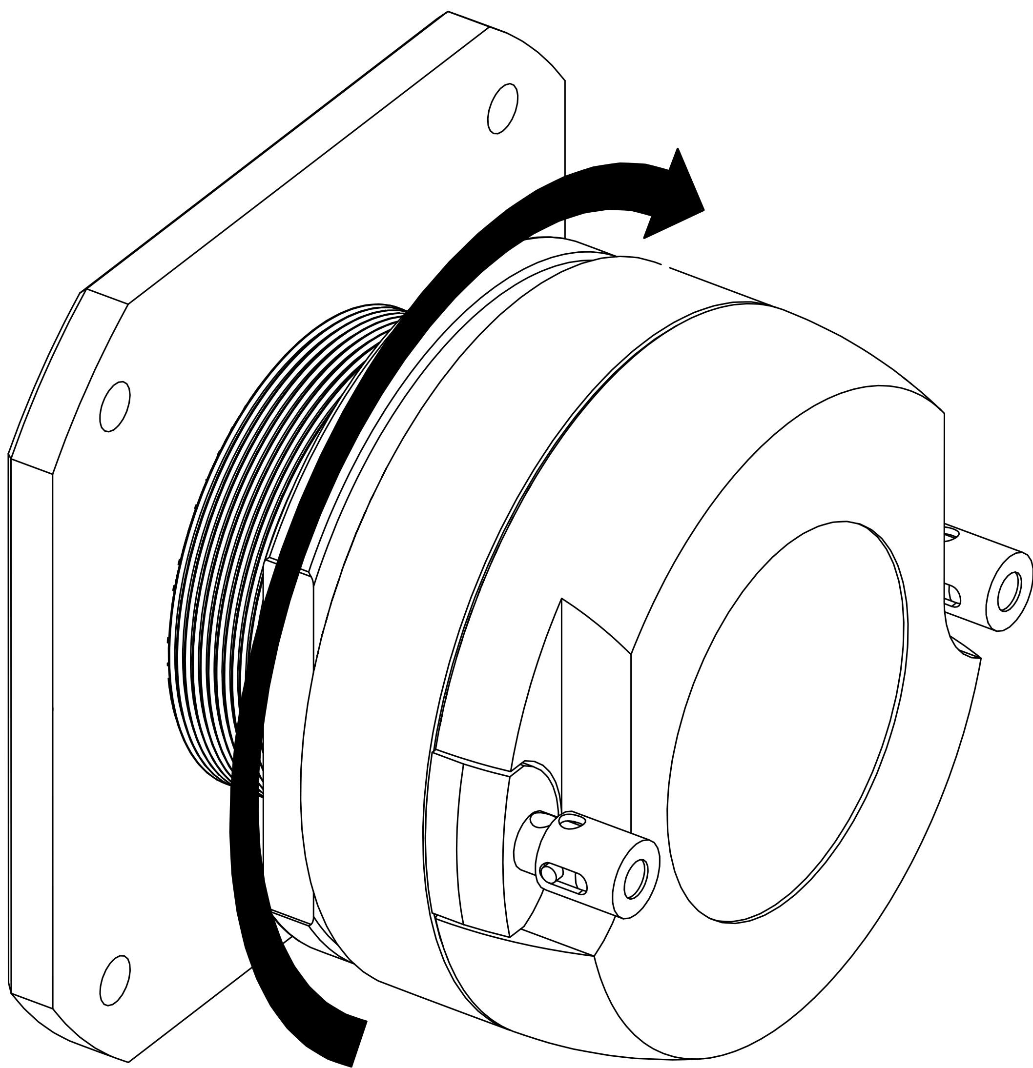
Coloque el tweeter en el orificio de montaje y después de encontrar la orientación deseada, marque los orificios para los tornillos de montaje que se perforarán con una broca de 7/64" (2.5 mm). Asegure el tweeter a la superficie con los tornillos suministrados.
