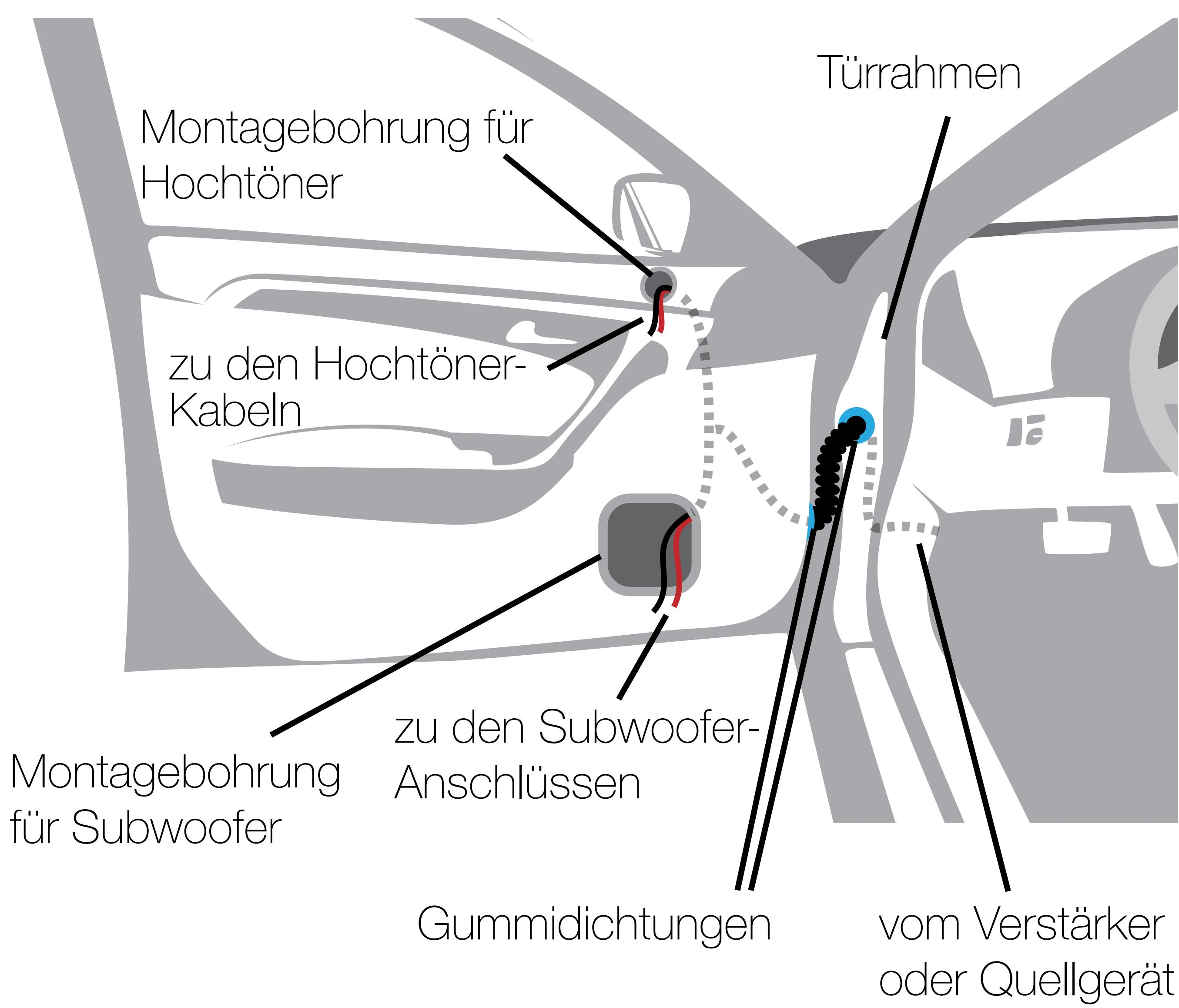
Wenn Sie für die Aussparungen der Lautsprecher Metall schneiden müssen, vermeiden Sie strukturelles Metall und Verstrebungen. Wenn der Türkörper und die Verkleidung das Gewicht des Lautsprechers nicht tragen können, sollte ein optionaler Verstärkungsring aus einem geeigneten Material am Türkörper befestigt oder aufgeklebt werden.
