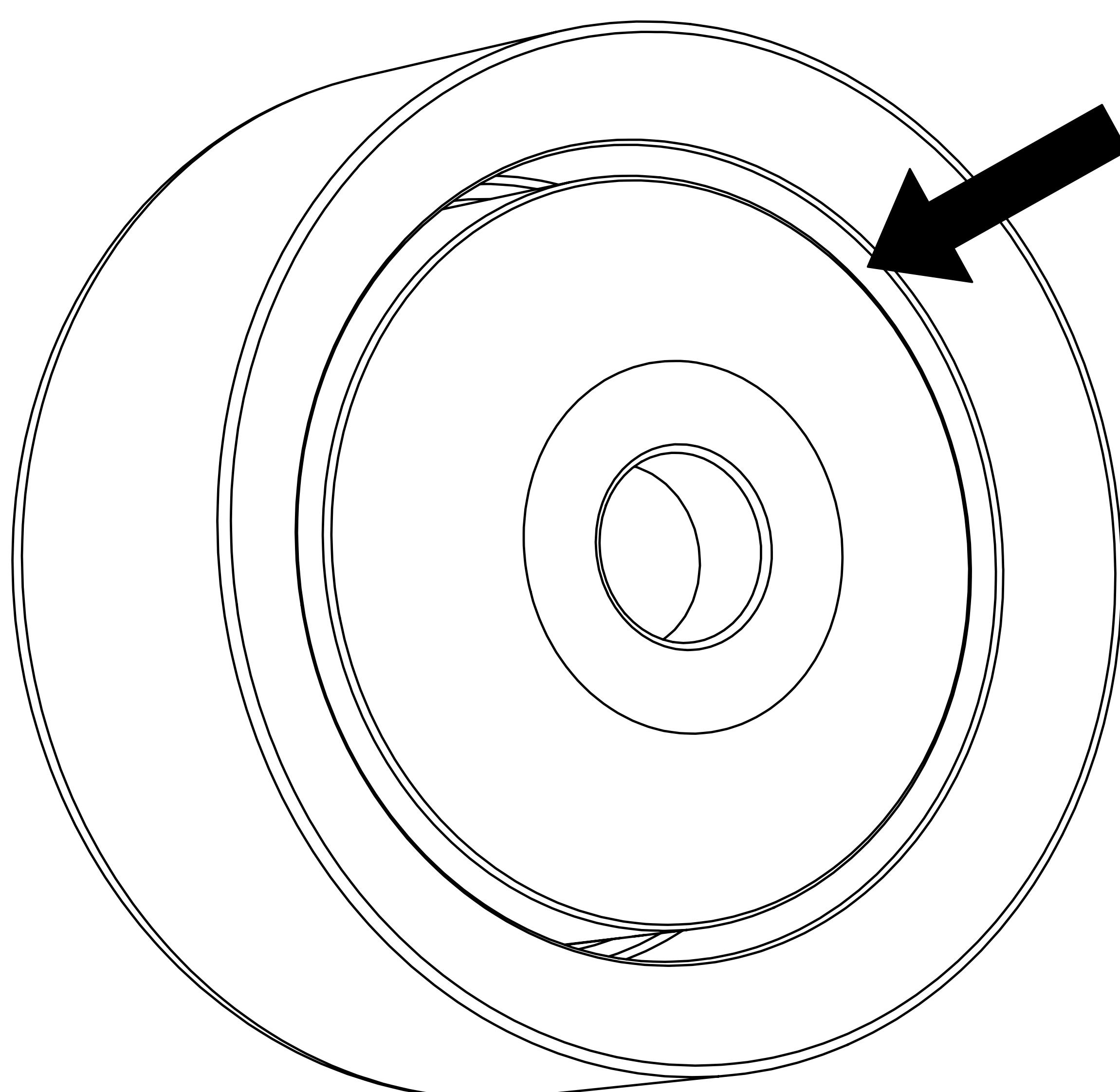
Installez la plaque de support, la rondelle et l'aimant de moteur dans le boîtier du moteur. Assurez-vous que l'aimant est installé avec l'espace de la bobine acoustique vers l'extérieur.
