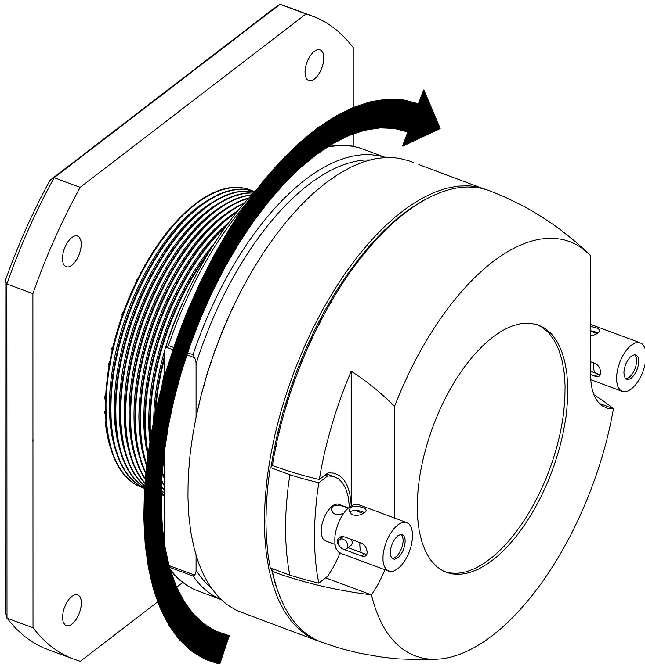
Placez le haut-parleur d'aigus dans le trou de montage et, une fois l'orientation souhaitée trouvée, marquez les trous des vis à percer avec une mèche de 2,5 mm (7/64e po). Fixez le haut-parleur d'aigus à la surface en utilisant les vis fournies.
