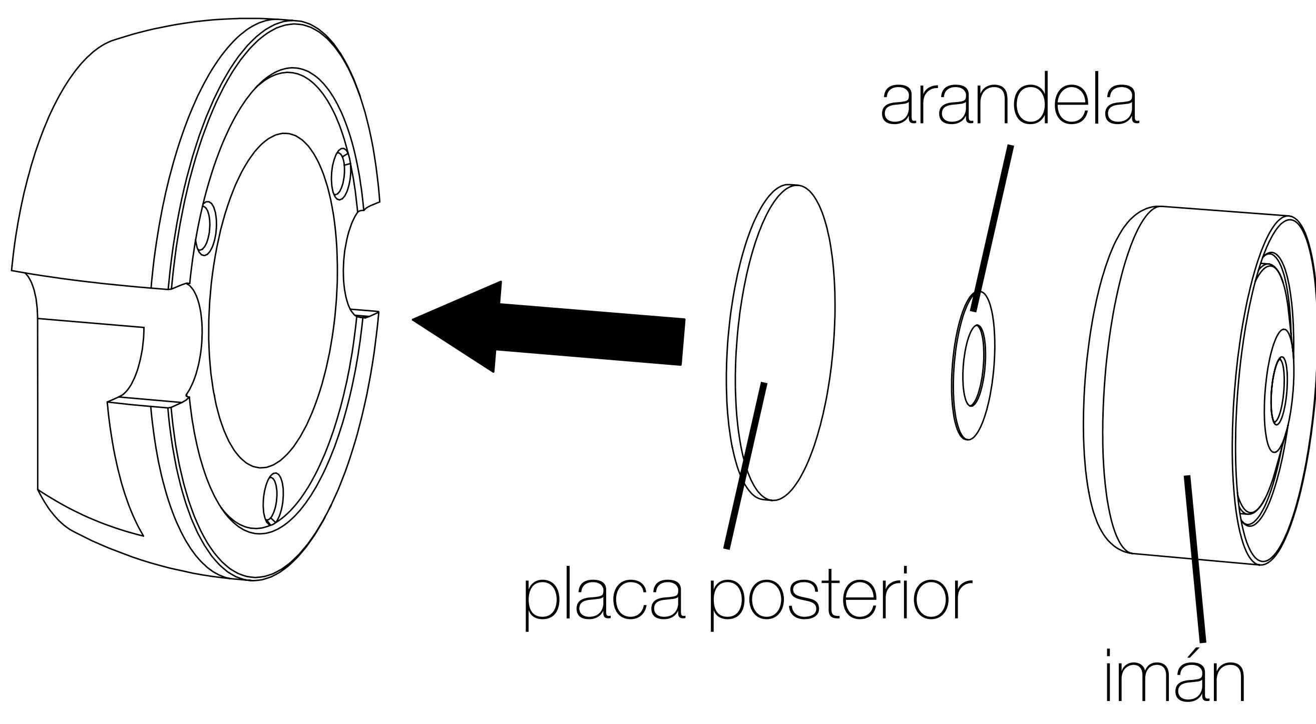
Instale con cuidado el nuevo ensamble de diafragma en la carcasa del motor alineando suavemente la bobina de voz del diafragma con el espacio de la bobina de voz del imán. Los orificios de montaje de la carcasa y el diafragma también deben estar alineados.
