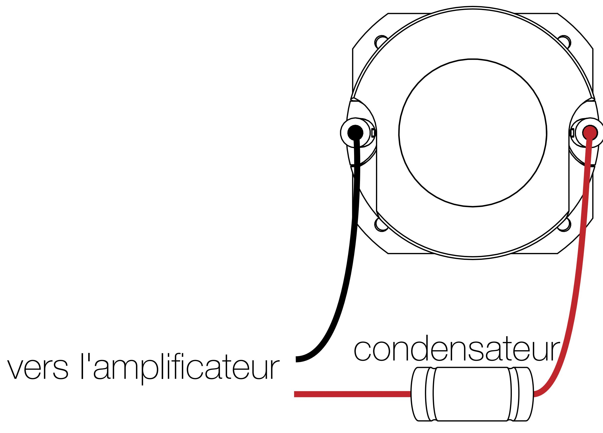
Si le niveau sonore du haut-parleur d'aigus est trop élevé, installez le condensateur et la résistance en série avec le câblage d'entrée positif du haut-parleur d'aigus comme indiqué.
