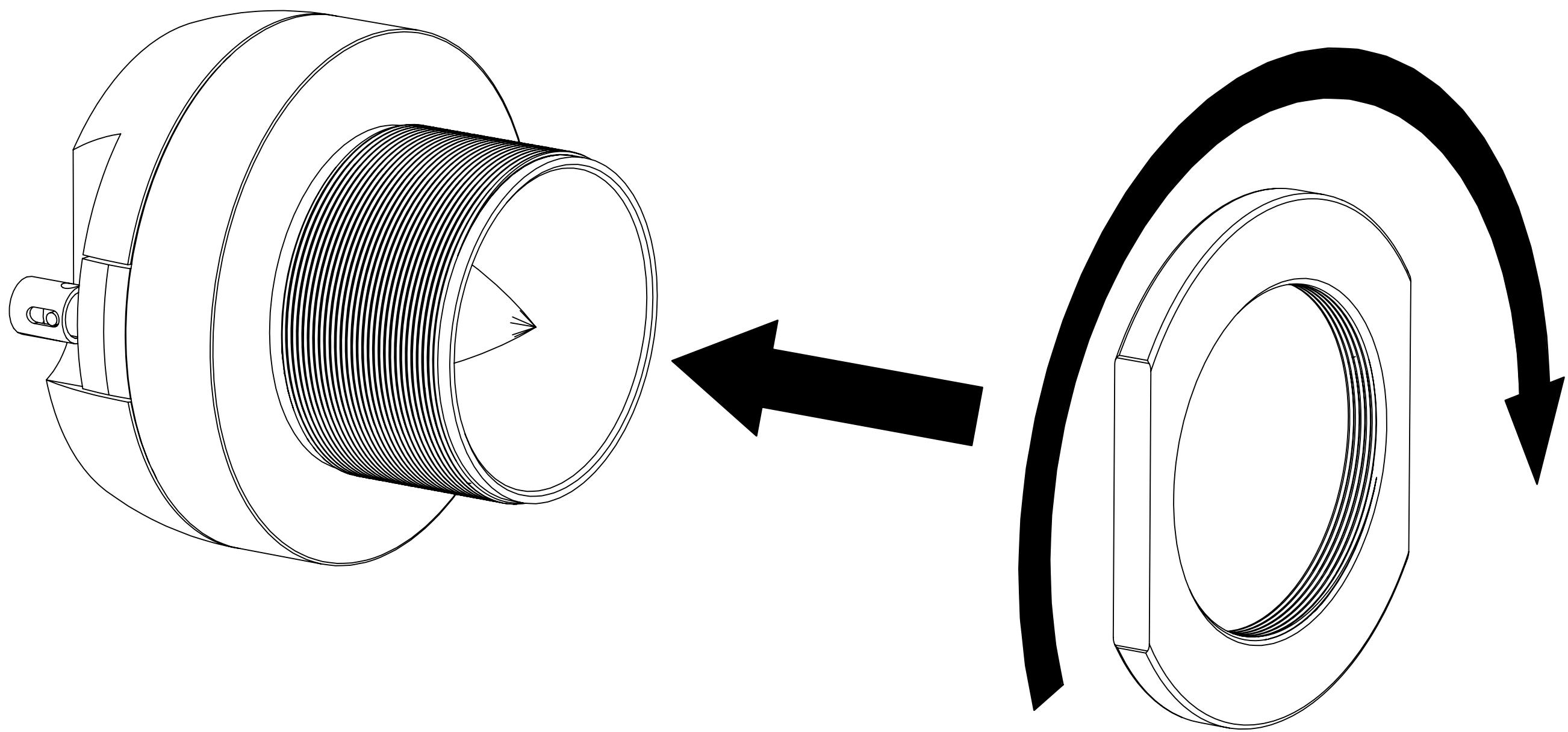
Instale la brida de montaje cuadrada en el tweeter, con la orientación deseada del tweeter y la brida.
