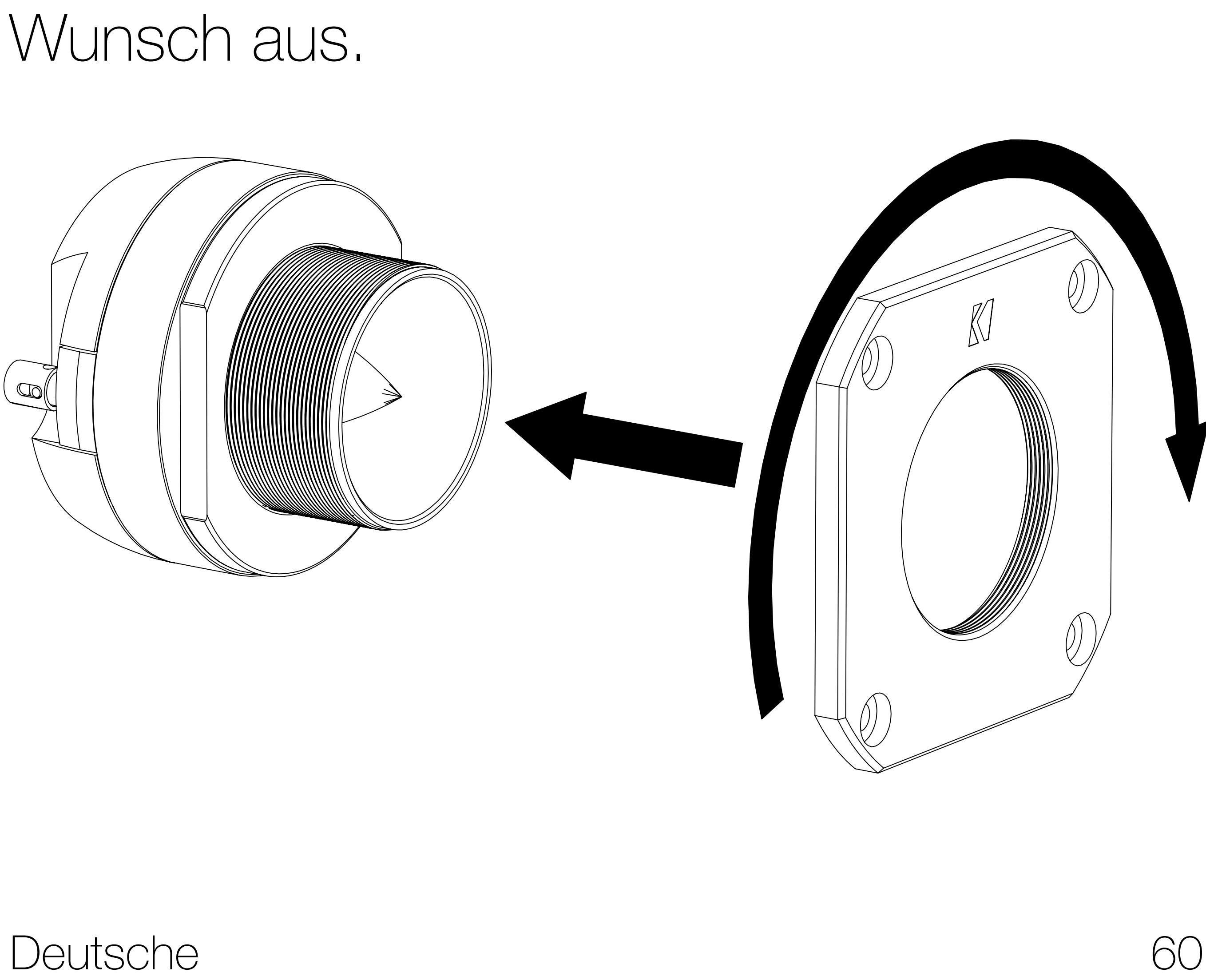
Ziehen Sie die Sicherungsmutter an, um den quadratischen Montageflansch zu befestigen.
