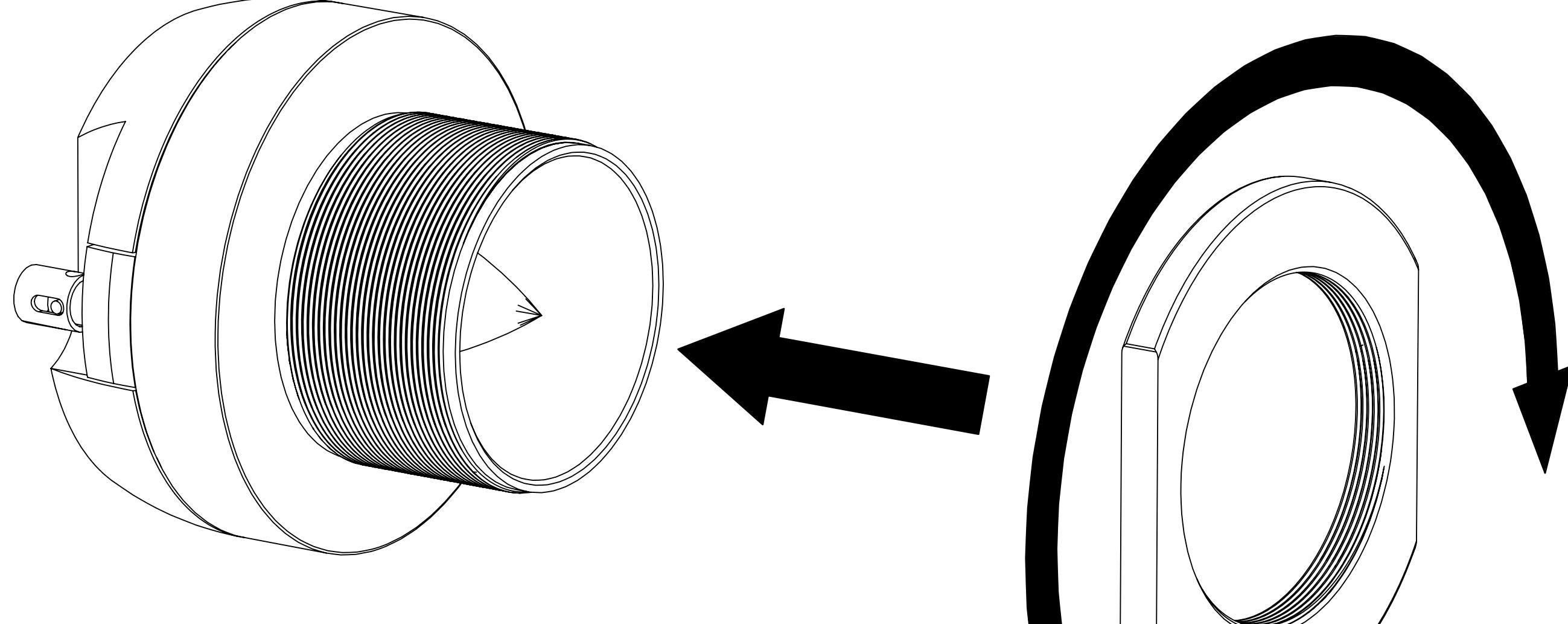
Placez le haut-parleur d'aigus dans le trou de montage et installez la bride de fixation ronde ou carrée dans le haut-parleur d'aigus, en orientant le haut-parleur d'aigus et la bride dans la direction souhaitée.
