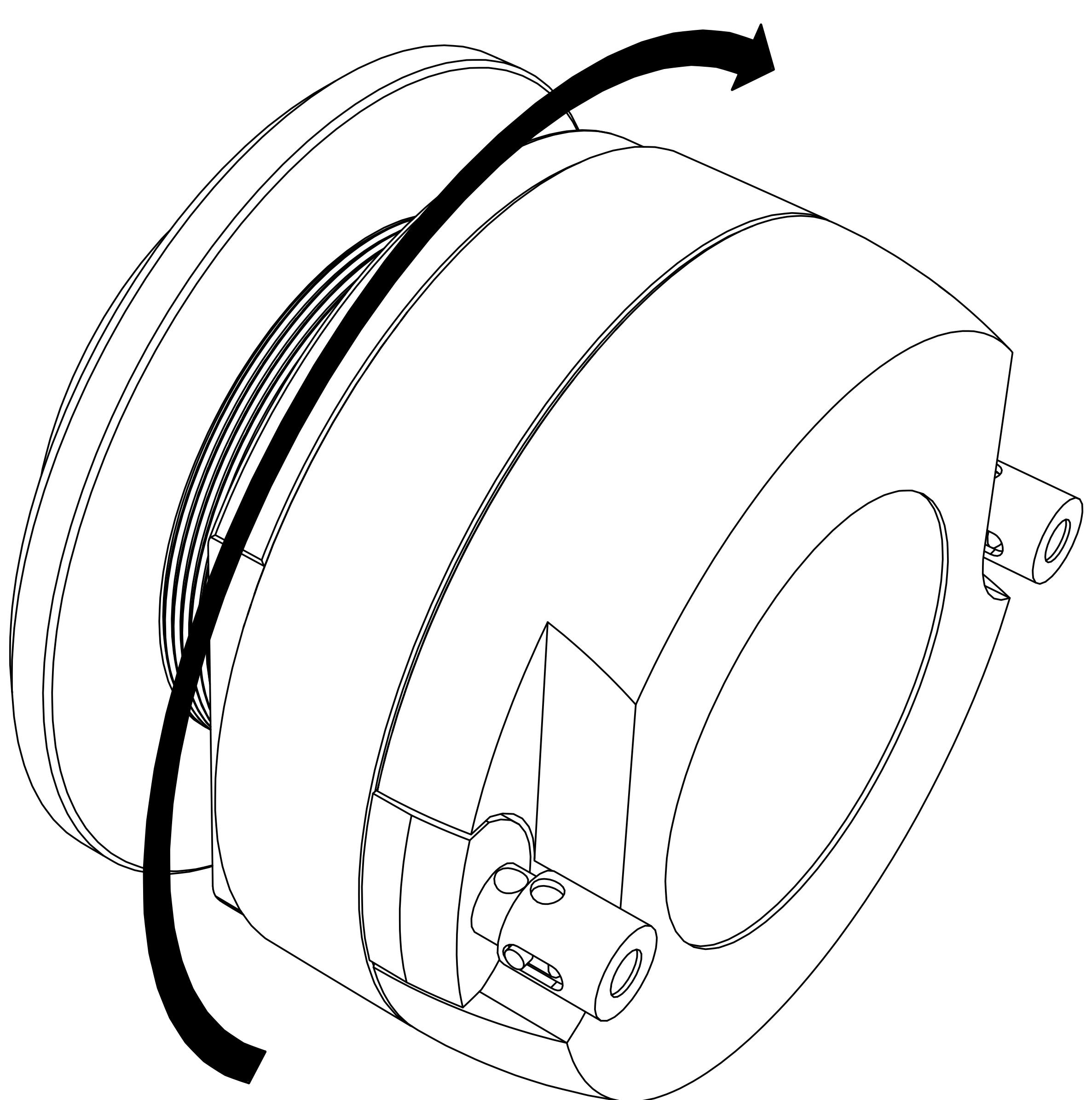
Para el **montaje en superficie**, corte un orificio circular en la superficie de montaje a 2,375" (60 mm) para el ST3TW, y a 3" (75 mm) para el ST4TW.
