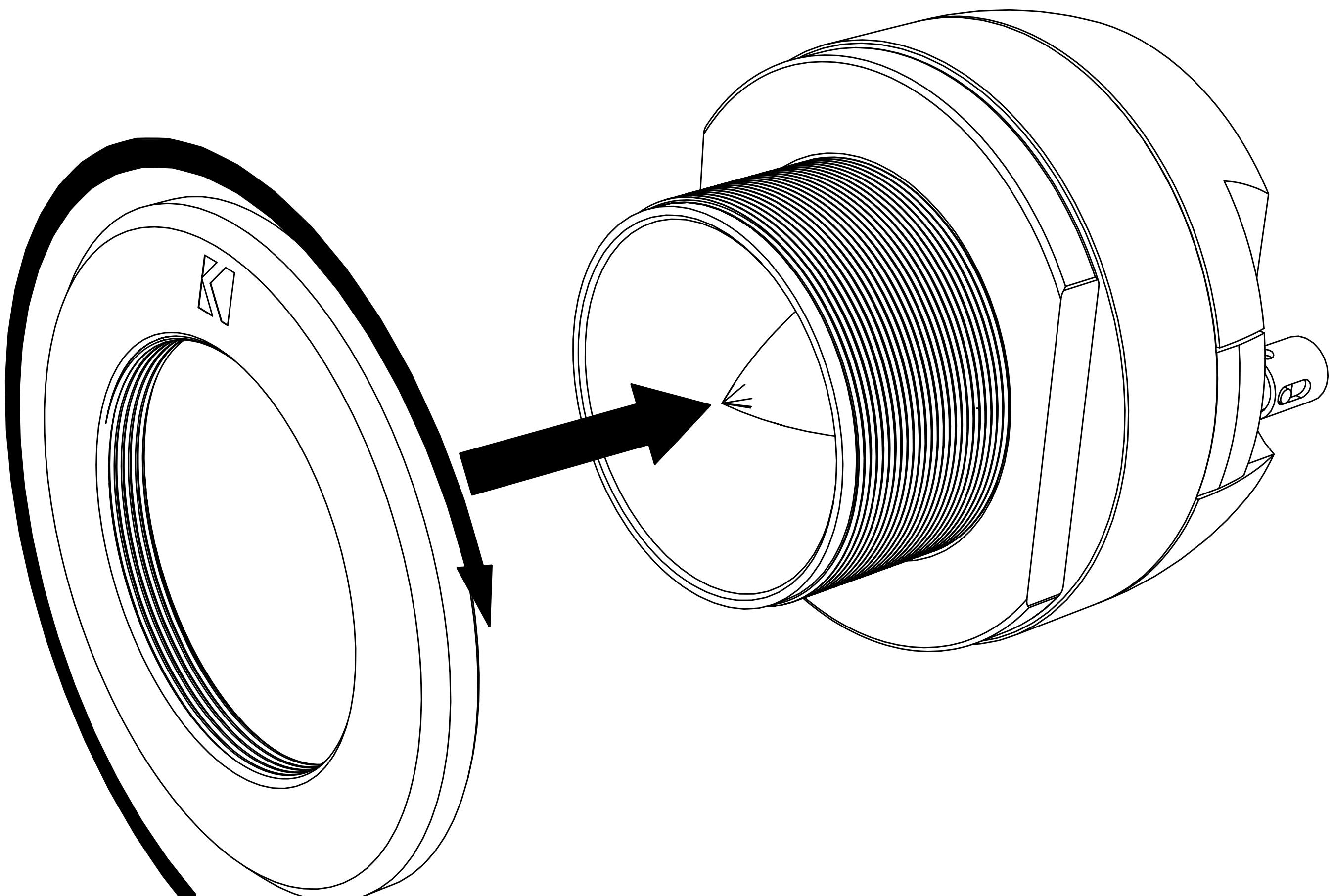
Apriete la tuerca de soporte en la superficie de montaje para asegurar el tweeter.
