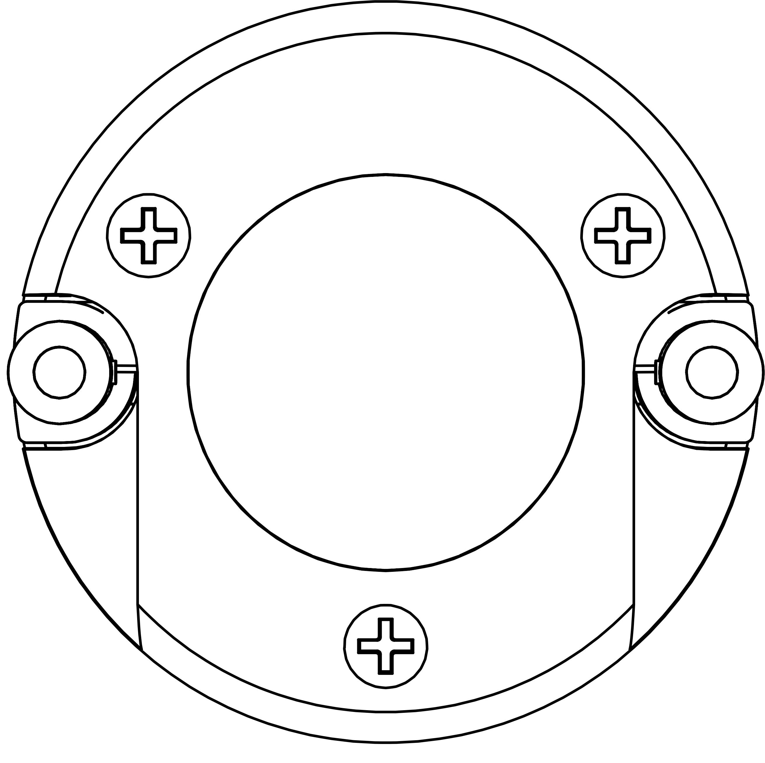
Demontieren Sie den Hochtöner und entsorgen Sie die beschädigte Membran-Baugruppe.
