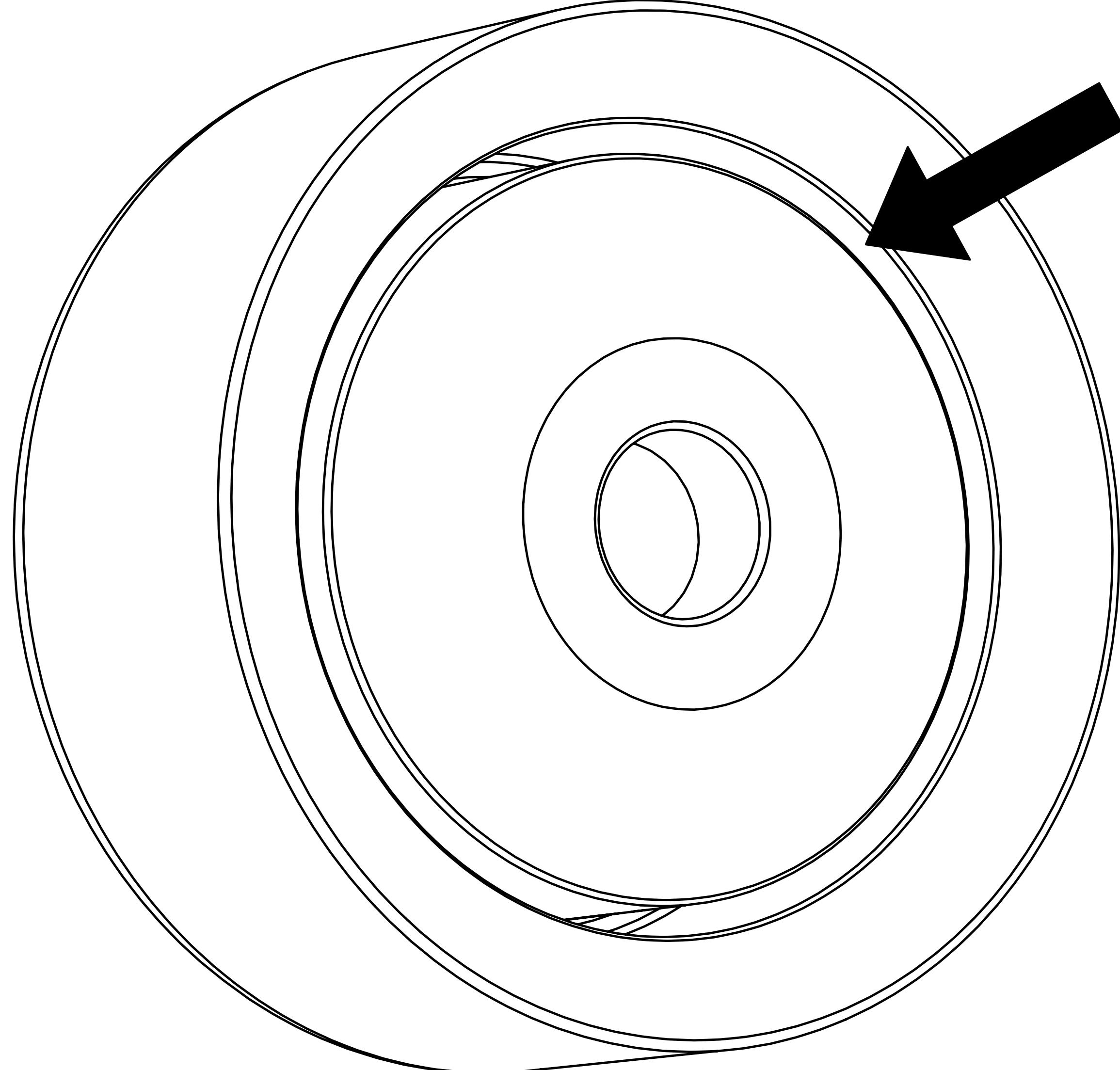
Instale la placa posterior, arandela e imán del motor en la carcasa del motor. Asegúrese de que el imán esté insertado respetando el espacio de la bobina de voz.
