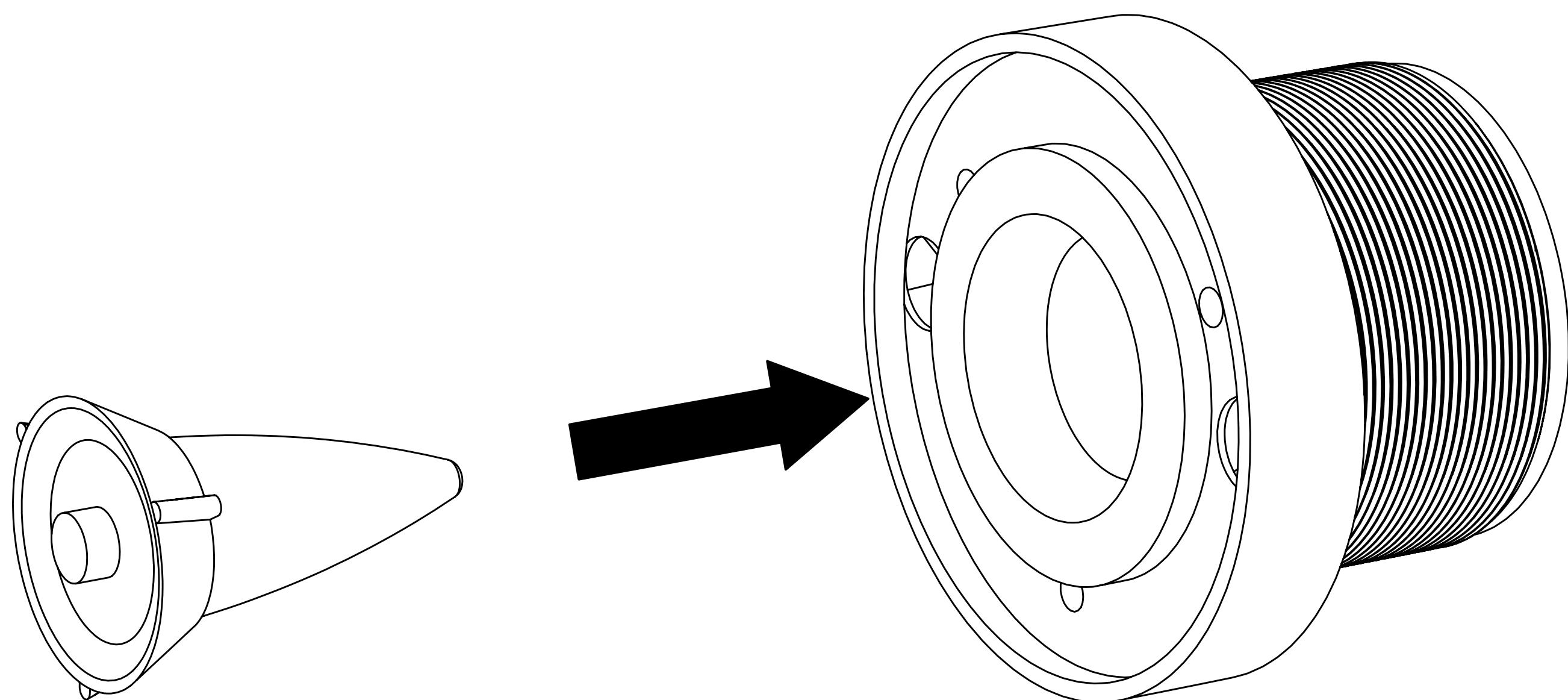
Instale el ensamble de la carcasa del motor en el ensamble de la bocina, asegurándose de que los tres orificios de los tornillos estén alineados.
