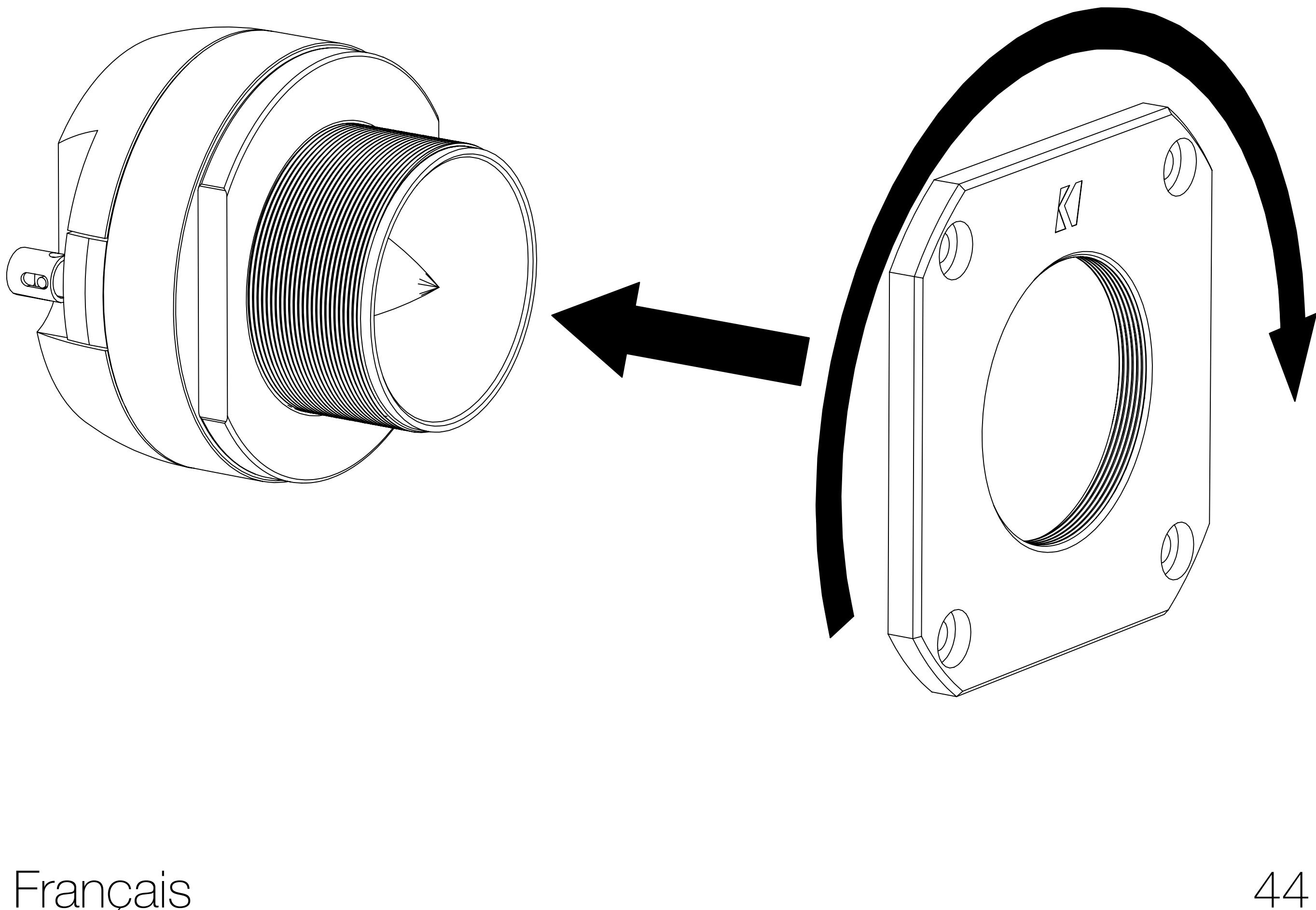
Serrez l'écrou de soutien pour maintenir la bride de fixation carrée en place.
