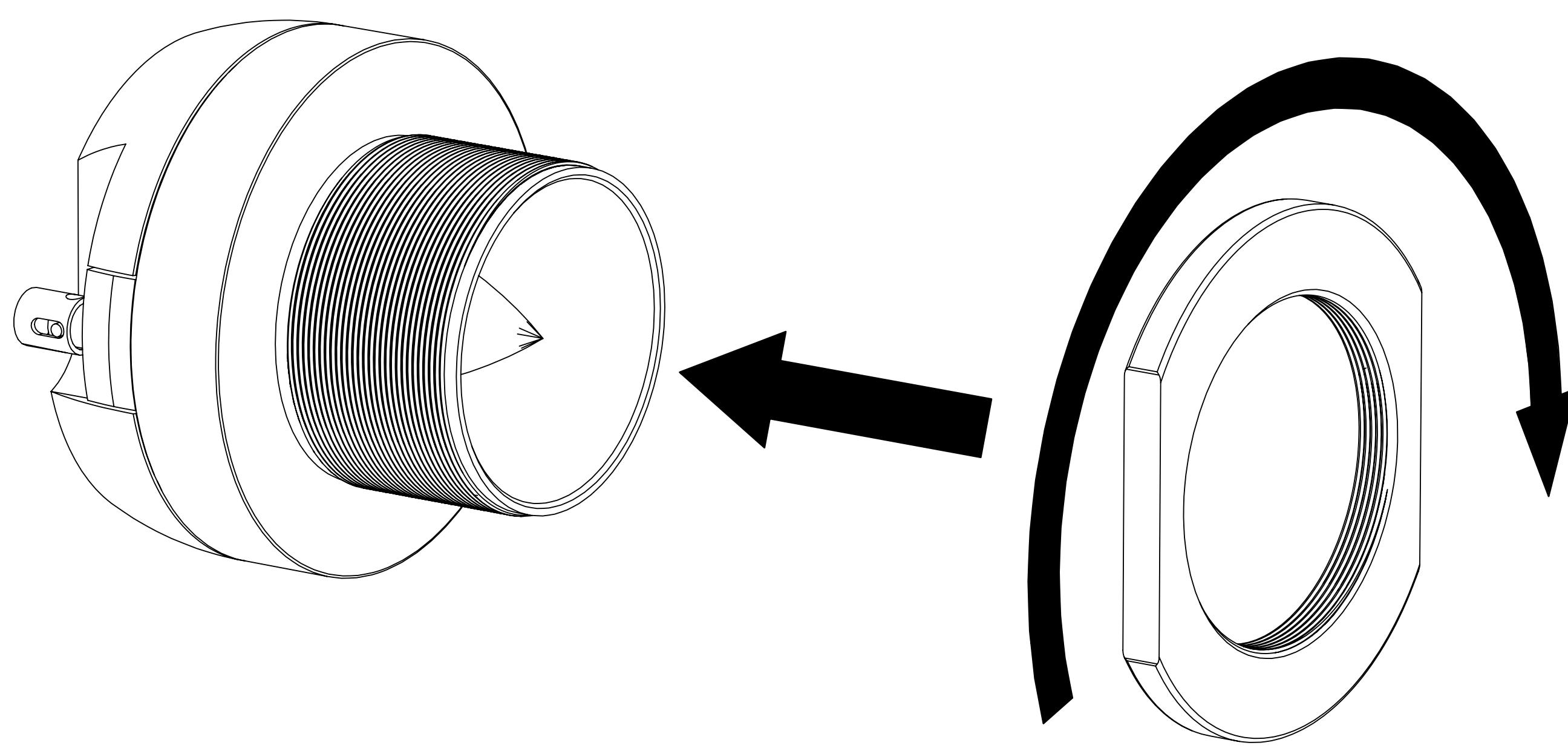
Coloque el tweeter en el orificio de montaje e instale la brida de montaje redonda o cuadrada en el tweeter, con la orientación deseada del tweeter y la brida.
