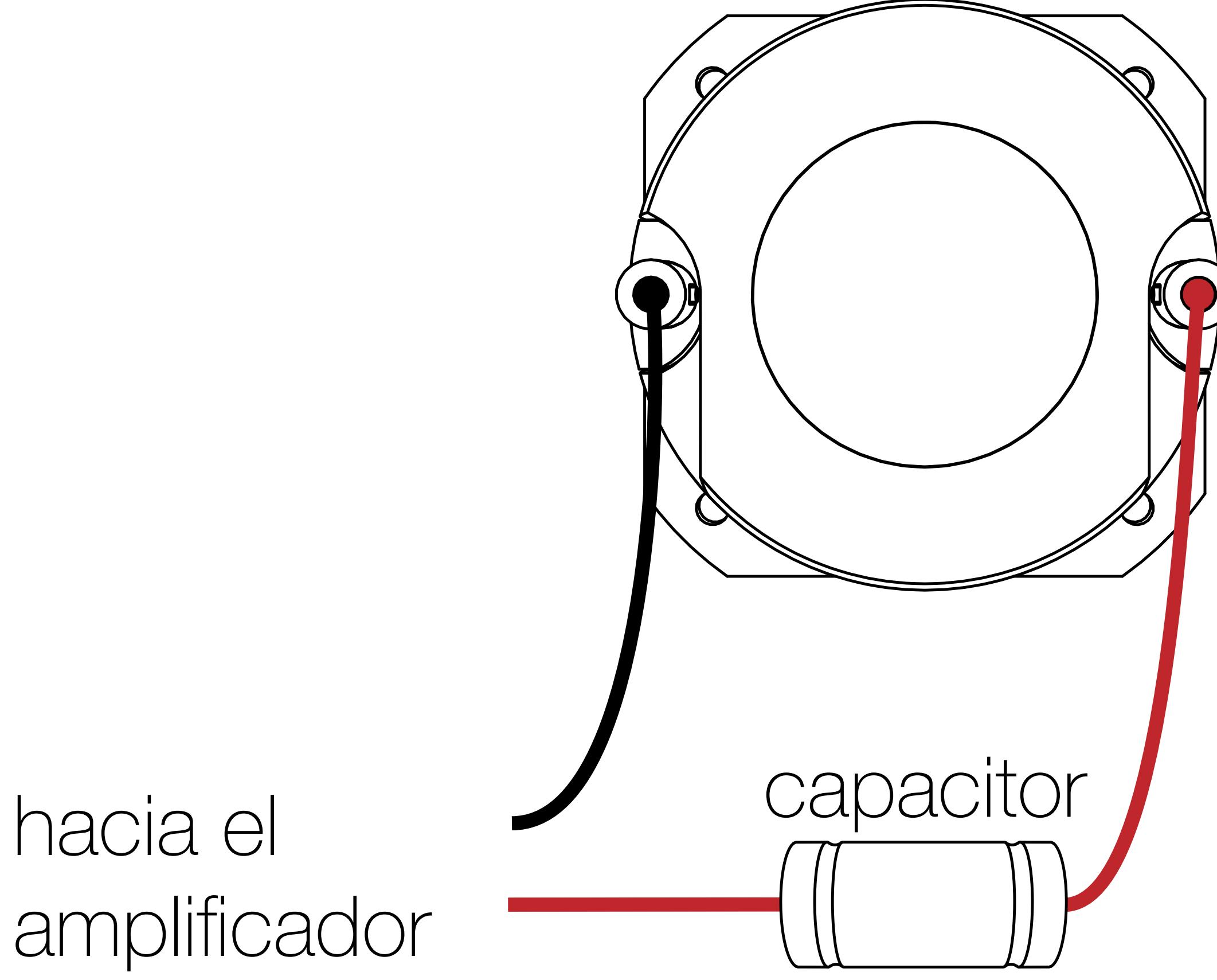
Si la salida del tweeter es demasiado alta, instale el capacitor y el resistor en serie con el cable de entrada del altavoz positivo del tweeter como se muestra en la imagen.
