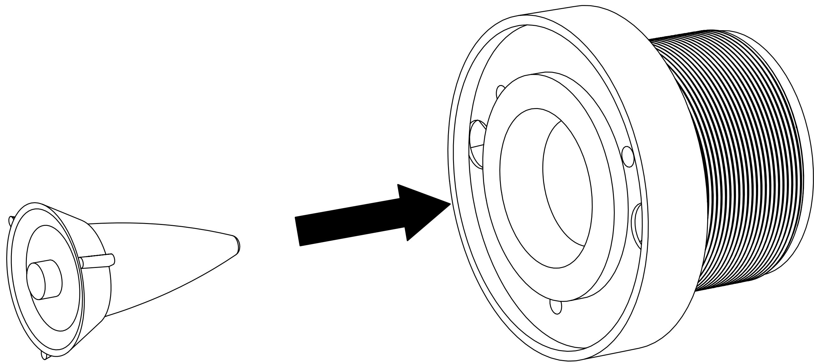
Installez l'ensemble du boîtier du moteur dans l'ensemble du pavillon, assurez-vous que les trois trous de vis des deux éléments soient alignés.
