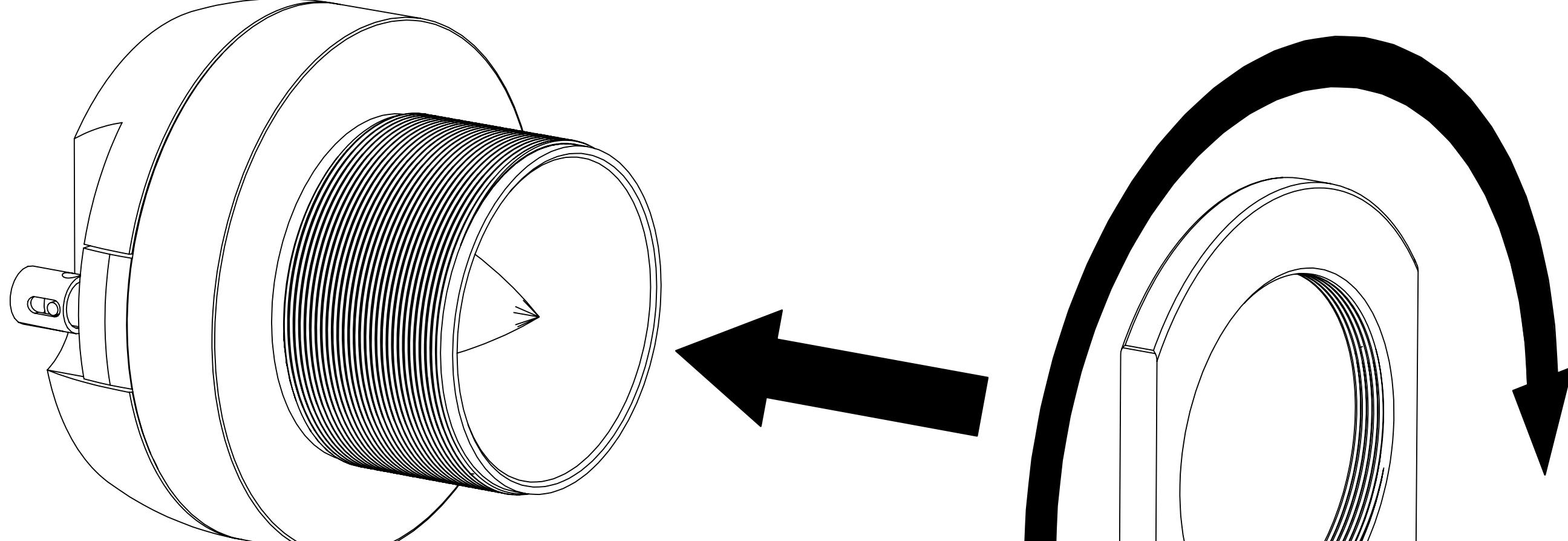
Setzen Sie den Hochtöner in das Montageloch und montieren Sie den runden oder quadratischen Montageflansch auf den Hochtöner. Richten Sie den Hochtöner und den Flansch dabei nach Wunsch aus.
