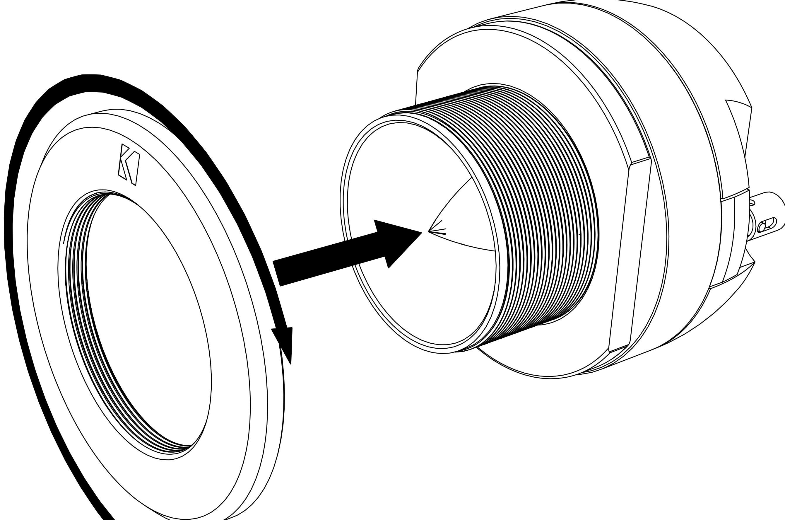
Serrez l'écrou de soutien vers la surface de montage pour sécuriser le haut-parleur d'aigus.
