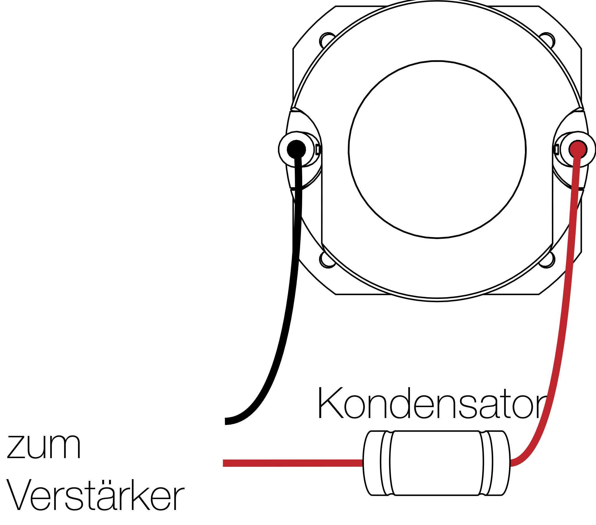
Wenn der Hochtöner zu laut ist, montieren Sie den Kondensator und den Widerstand wie abgebildet in Reihe geschaltet mit dem positiven Lautsprechereingangskabel des Hochtöners.
