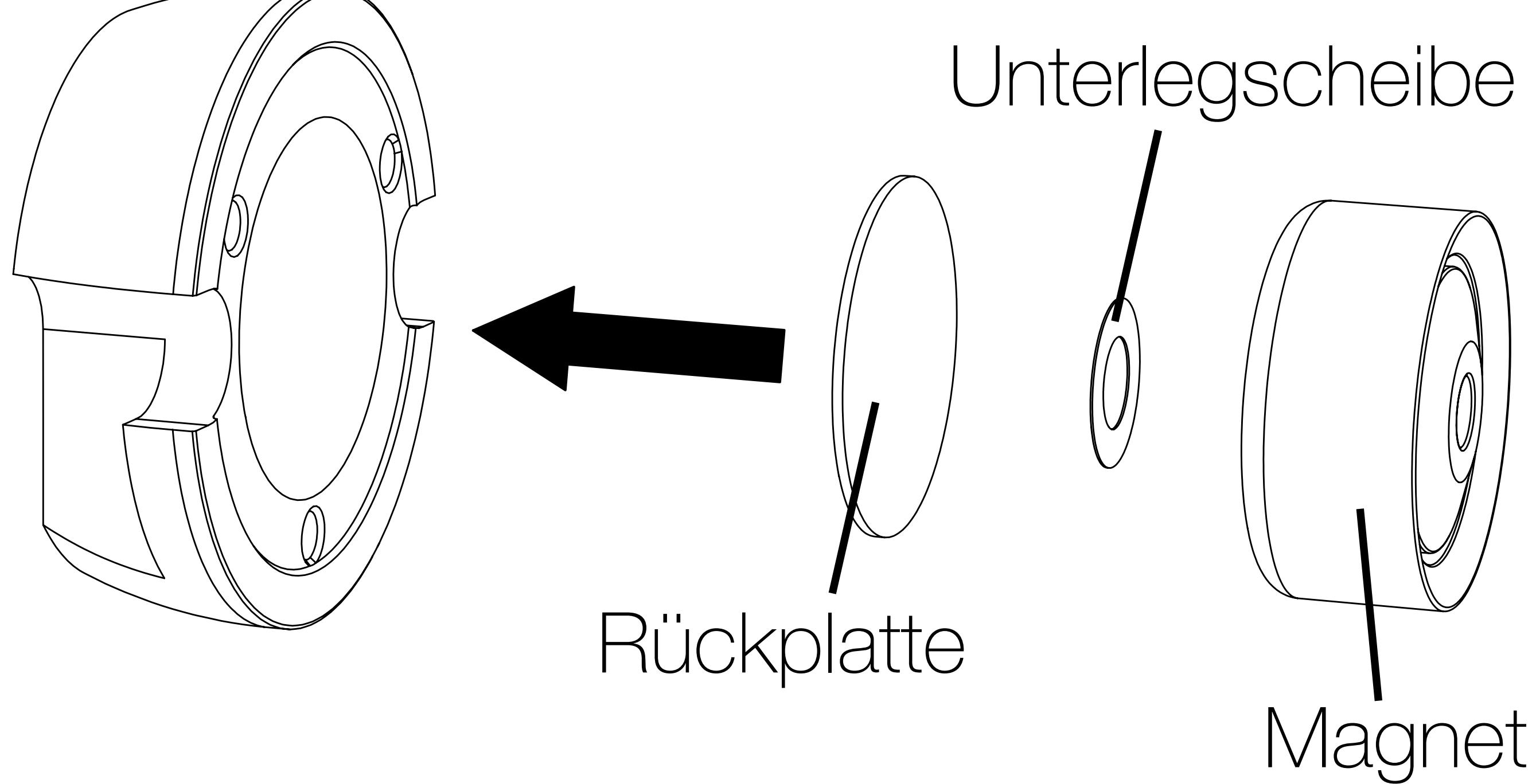
in das Antriebsgehäuse ein, indem Sie die Schwingspule der Membran vorsichtig auf den Schwingspulenspalt des Magneten ausrichten. Die Schraubenlöcher des Gehäuses und der Membran sollten ebenfalls übereinstimmen.
