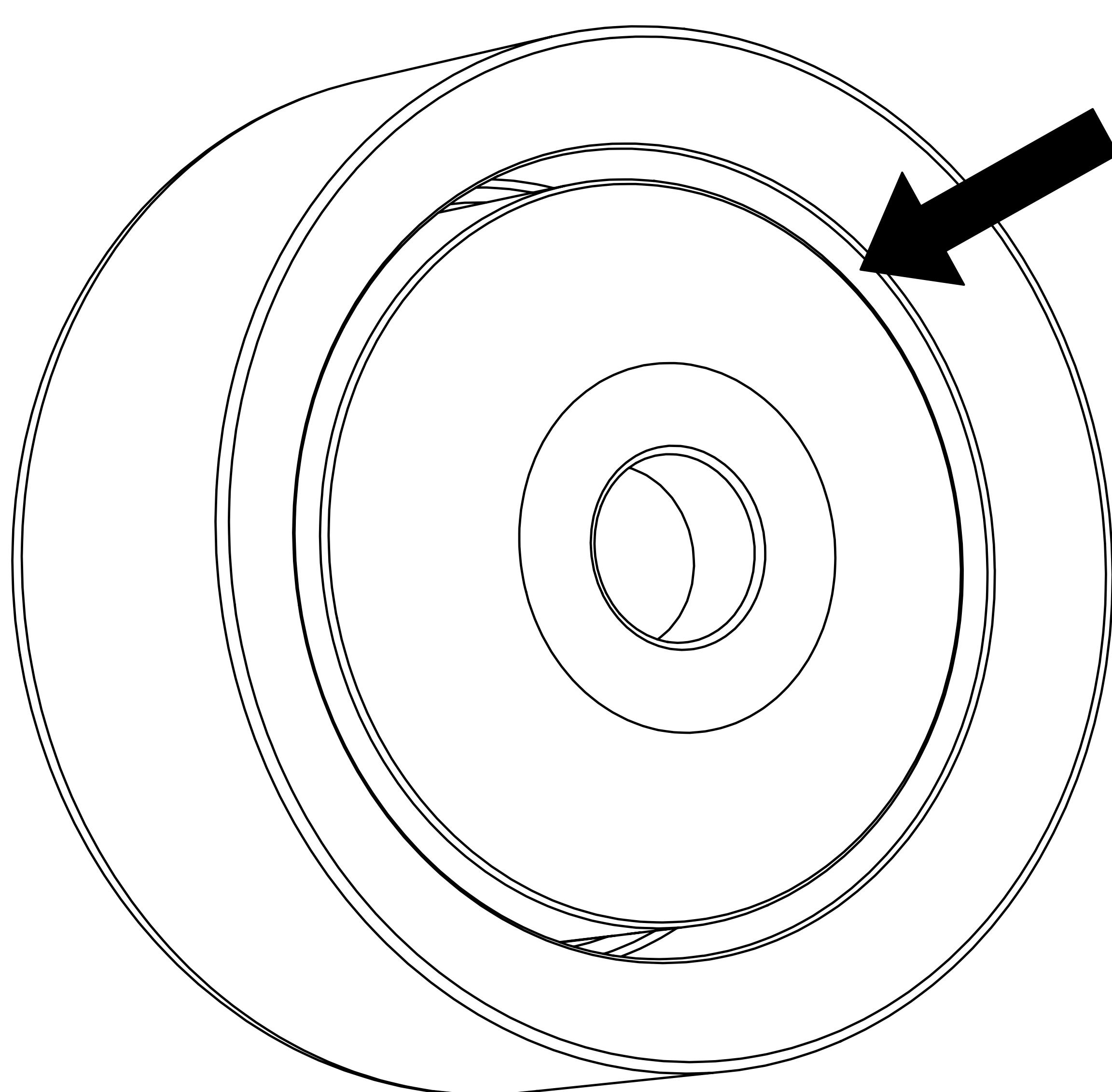
Bauen Sie die Rückplatte, die Unterlegscheibe und den Antriebsmagneten in das Antriebsgehäuse ein. Achten Sie darauf, den Magneten mit dem Schwingspulenspalt nach außen einzusetzen.
