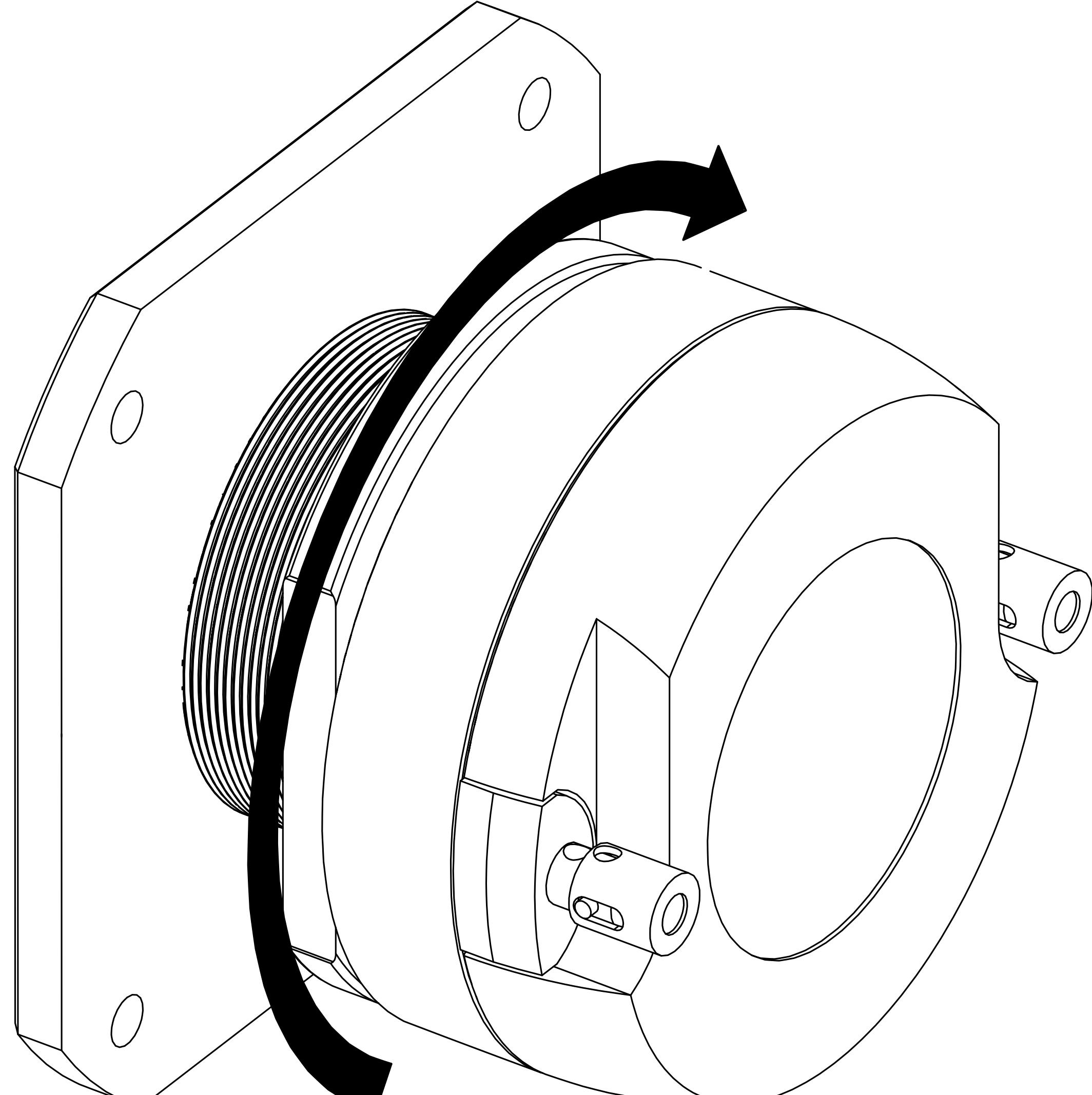
gefunden haben, setzen Sie den Hochtöner in das Montageloch und markieren Sie die Befestigungslöcher, die mit einem 7/64-Zoll-Bohrer (2,5 mm) gebohrt werden. Befestigen Sie den Hochtöner mit den mitgelieferten Schrauben an der Oberfläche.
