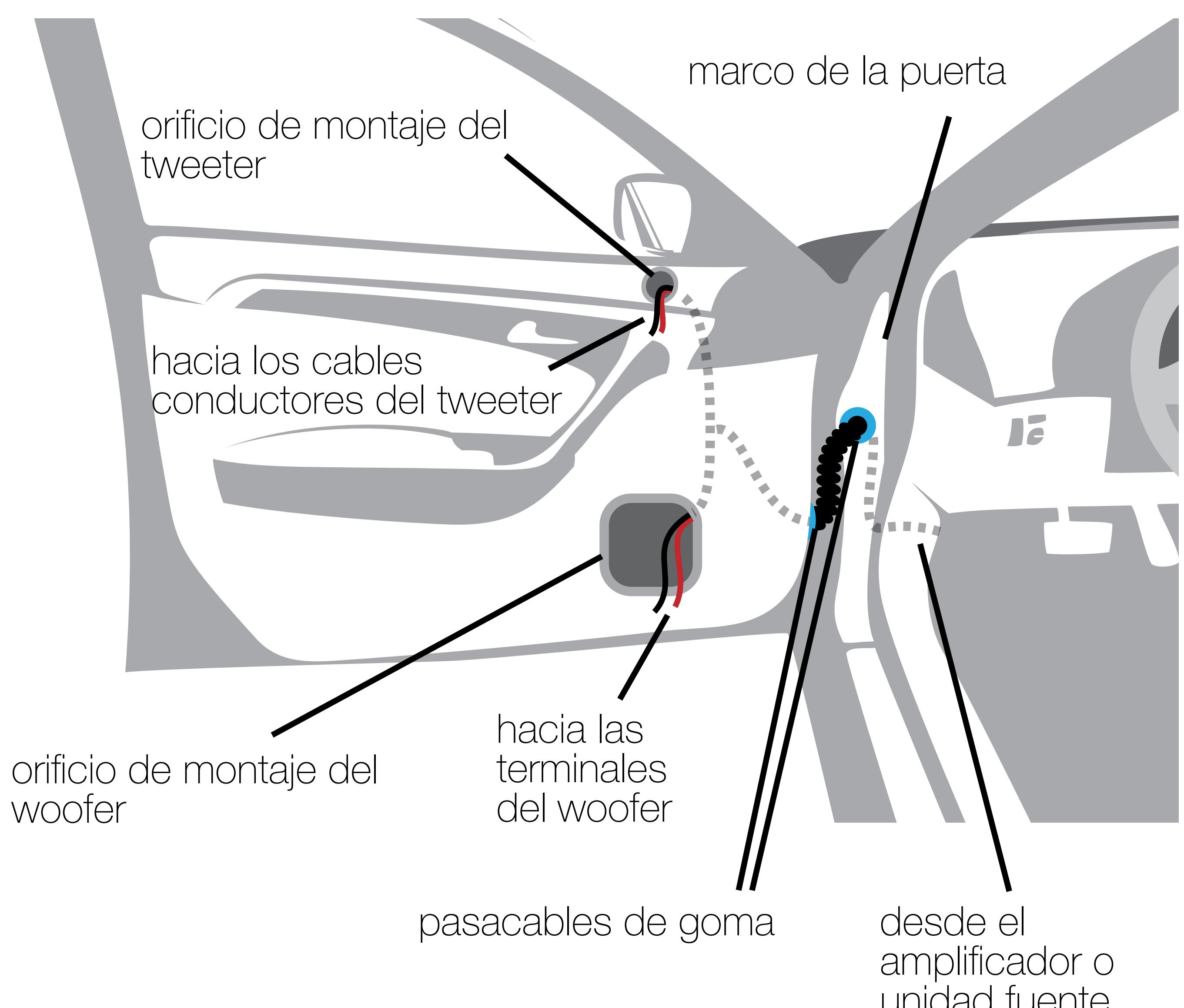
Si las ubicaciones de las aberturas del altavoz requieren que corte metal, evite las estructuras metálicas y los soportes. Si el cuerpo de la puerta y el panel no pueden soportar el peso del altavoz, un aro de refuerzo opcional fabricado con material apropiado puede ser sujetado o adherido al cuerpo de la puerta.
