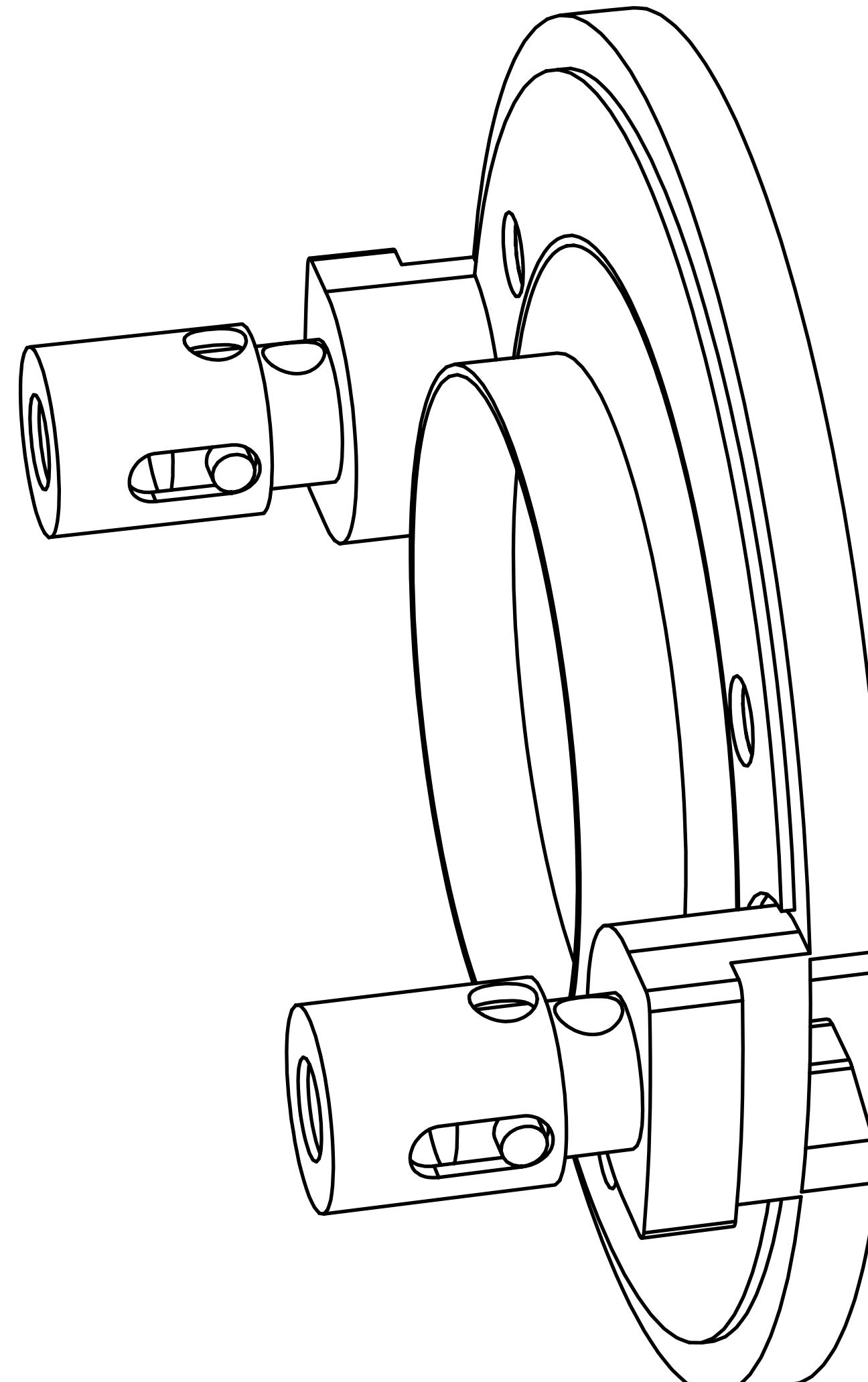
Reinigen Sie den Antriebsmagneten von Schmutz und konzentrieren Sie sich dabei auf den Schwingspulenspalt.
